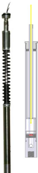
La soluzione tecnologica è rappresentata da una centralina di controllo in grado di regolare in tempo reale le caratteristiche di smorzamento di una forcella e di un monoshock di tipo *magnetoreologico*.
